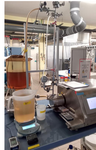
Pilote de filtration Cogent (MFT)
